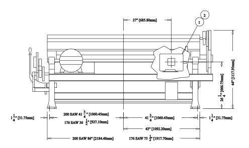
1] 176 SAW DRIVE MOTOR - 3 HP - 50 HZ / 2 HP - 60 HZ
