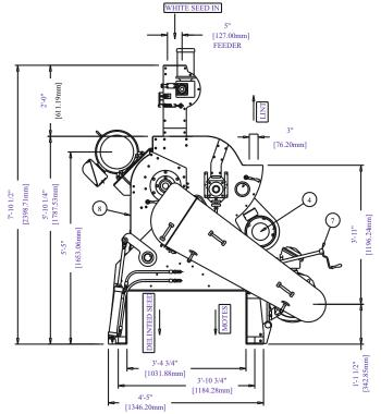
1] FEEDER MOTOR - 1 HP - 380/230-440V / 3PH / 50-60HZ 2] FLOAT MOTOR - 25 HP - 1450/1750RPM - 380/230-44<u>0V / 3PH / 50-60HZ</u>
