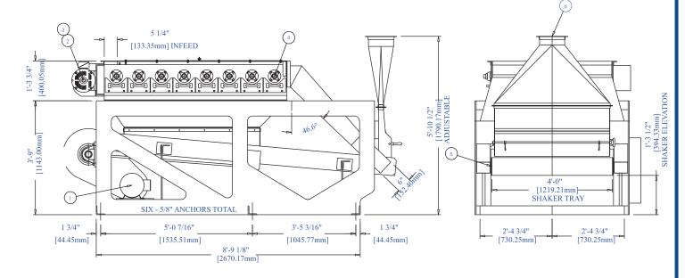
1] SHAKER MOTOR - 2HP-1440/1200 RPM-380/230-440V / 3 PH / 50-60HZ
